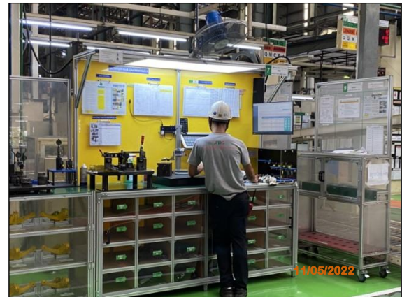
ภาพที่ 2.2-37 โคมไฟและหลอดไฟฟลูออเรสเซนต์เฉพาะจุด
