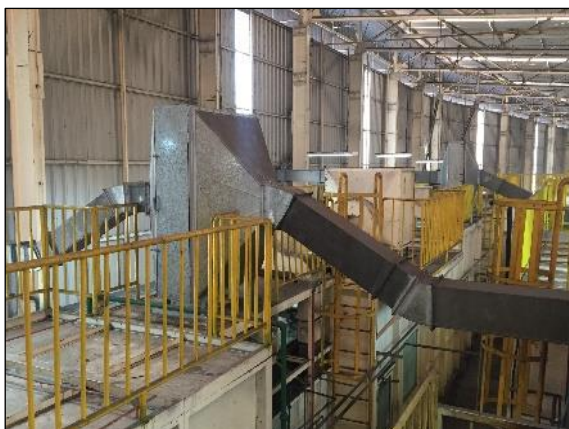
ภาพที่ 2.2-11 ระบบดูดซับก๊าซ (Activated Carbon)
